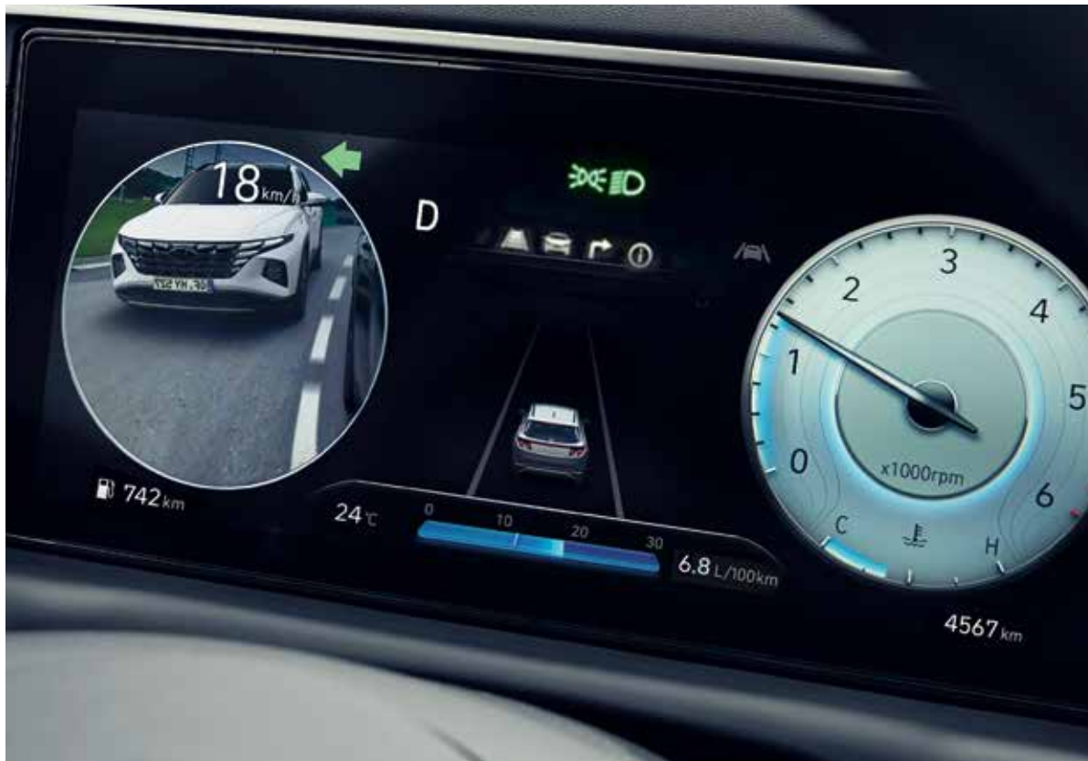
Slikovni prikaz območja mrtvega kota v instrumentni plošči (BVM) Sistem prikazuje dogajanje v mrtvem kotu. Zagotavlja varno menjavo voznih pasov, saj ima voznik jasno predstavo kaj se dogaja ob strani za njim.
