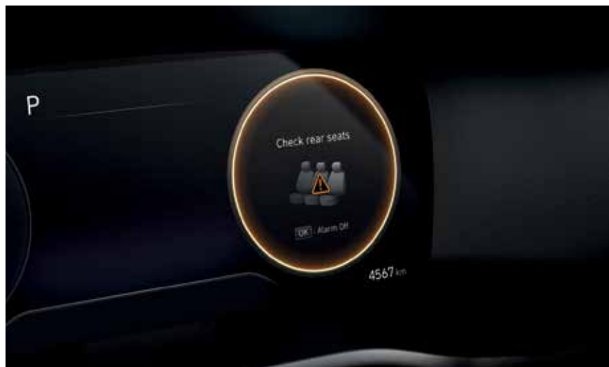
Sistem za nadzor voznikove zbranosti. Sistem za opozarjanje na prisotnost potnikov na zadnjem sedežu.
