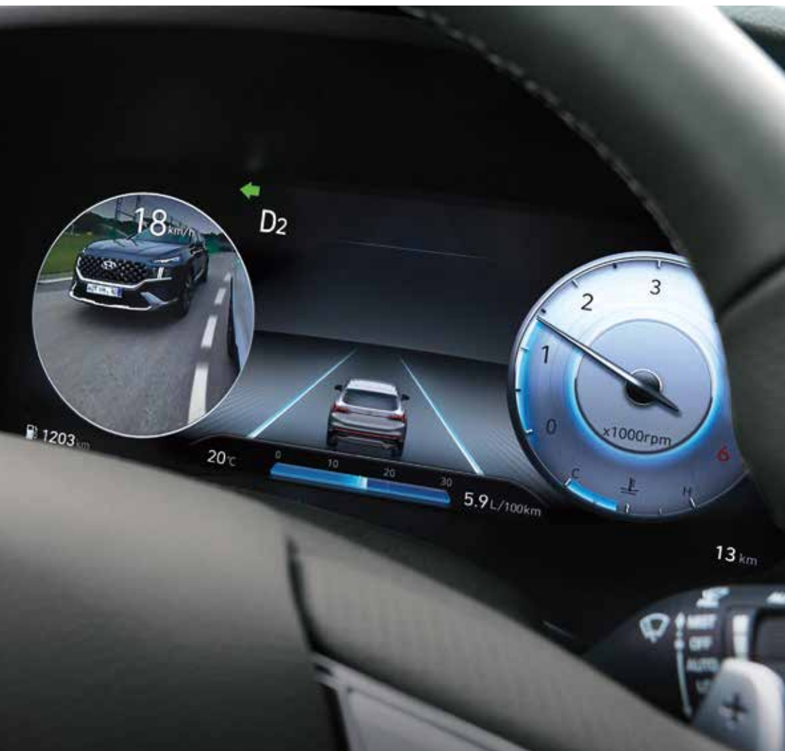
12,3-palčni LCD zaslon instrumentne plošče s slikovnim prikazom območja mrtvega kota.
